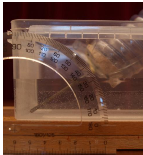
Obr.2: Rôzne uhly \theta , ktoré zvierá skrutka s vodorovnou rovinou
