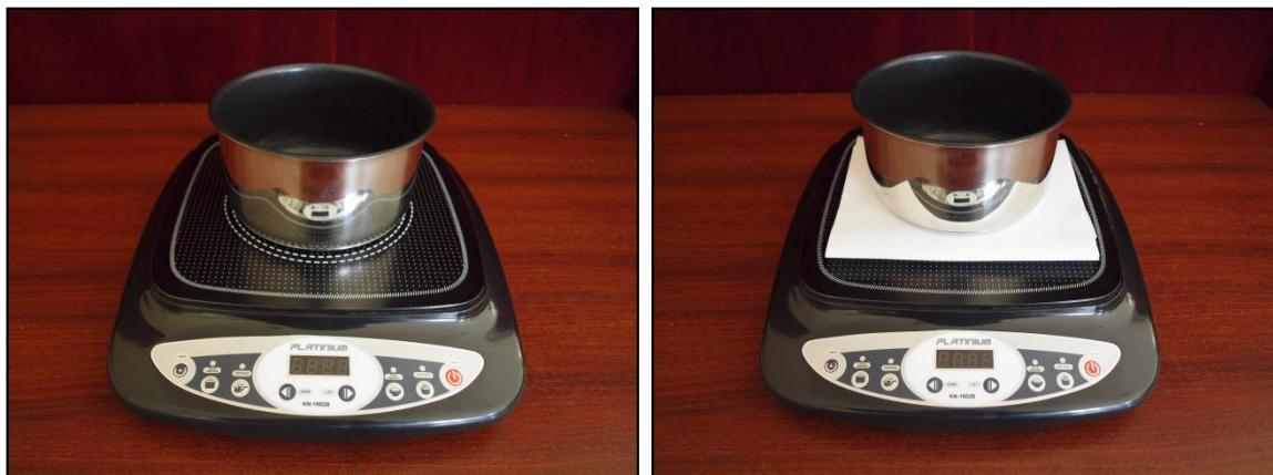
Obr.1: Hrnec s minimálnym množstvom vody zohrievaný na indukčnom variči bez/s penovým polystyrénom
